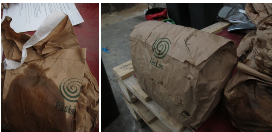
Bild 4. TV tejp följt med skyddspapper, misslyckad förslutning, TH väl försluten påse
