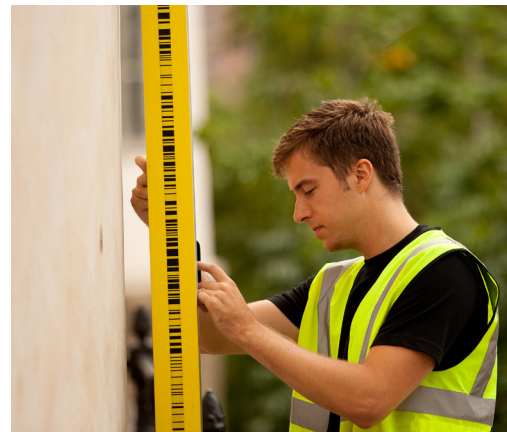
Besiktning före och efter. Alla byggnader inom en radie av 150 meter från vårt arbete besiktas av ett oberoende besiktningsföretag.
